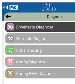
In der Kopfzeile des Displays steht der Name des Menüs, in dem Sie sich gerade befinden, z. B. Menü **Diagnose**. In den folgenden Zeilen sind die Namen der Untermenüs aufgelistet.
