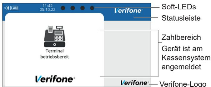
Display im Grundzustand (wenn das Gerät nicht am Kassensystem angemeldet ist)
